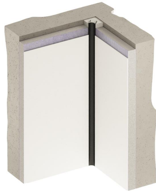
Оформление декоративного стыка на внутреннем углу стены
