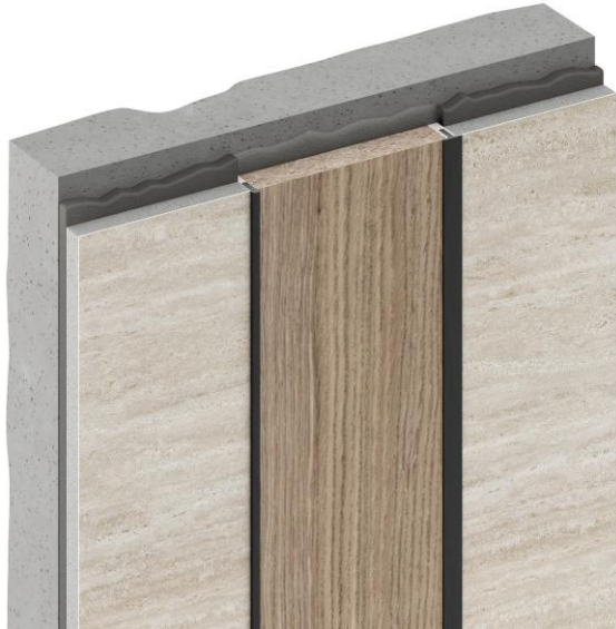
Вариант монтажа профиля между панелями и плиткой
