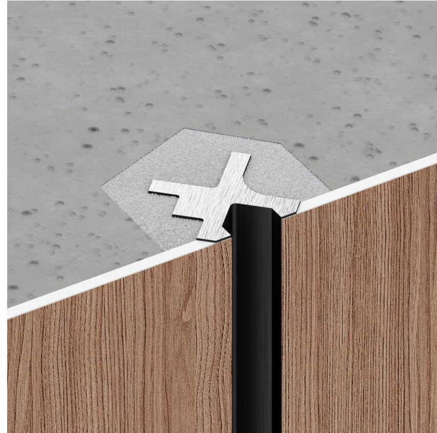
Вариант монтажа между шпонированными обоями
