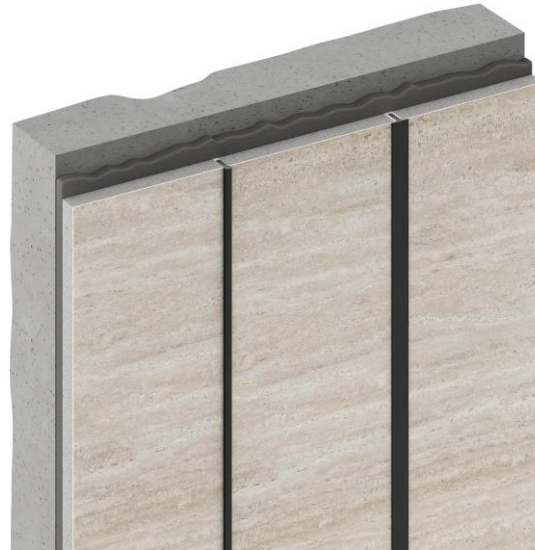
Вариант монтажа между плиткой
